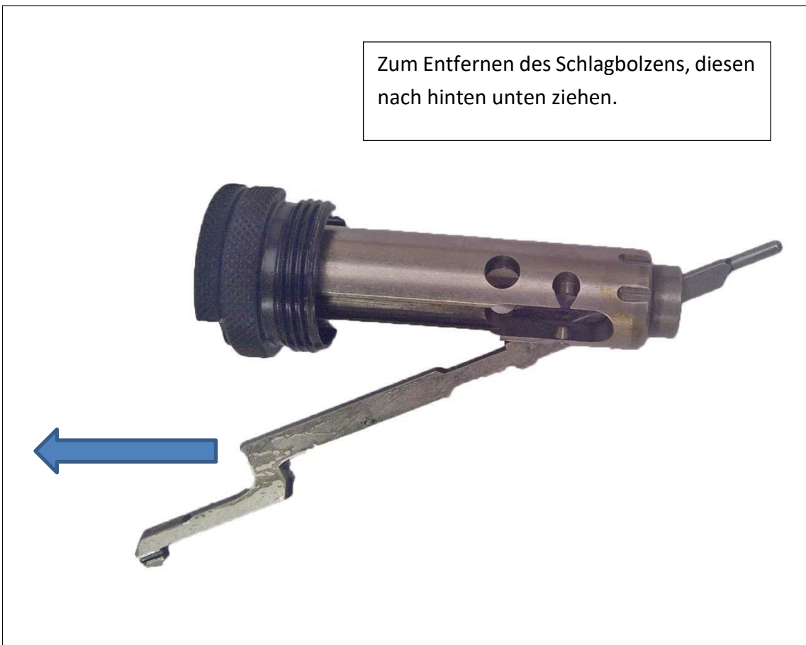
Abbildung 109. Entfernen des Schlagbolzens.
