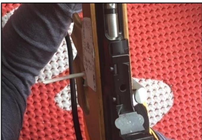
Abbildung 59. Positionierung des verlängerten Abzugsfingers am Züngel
