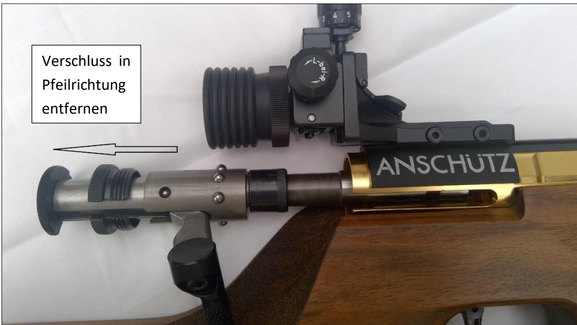
Abbildung 97. Verschluss in Pfeilrichtung entfernen.
